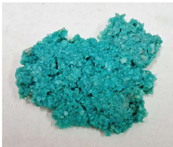
Figura 14 - Bioadsorvente após ensaio de quantificação de massa adsorvida do corante azul dianativo HFG em pH 3,0.
