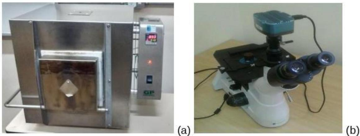
**Figura 2: Equipamentos existentes no laboratório de metalografia do IFSP – câmpus Catanduva: (a) Forno; (b) Microscópio .**
