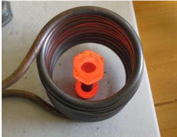
**Figura 13** – Exemplo de aplicação de aquecimento através de indução. ([www.manningsusa-uk.com](http://www.manningsusa-uk.com))
