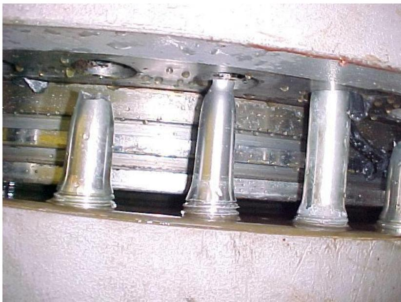
**Figura 9** – Rompimento de parafusos durante teste hidrostático. Foram usados parafusos de material diferente do de projeto.
