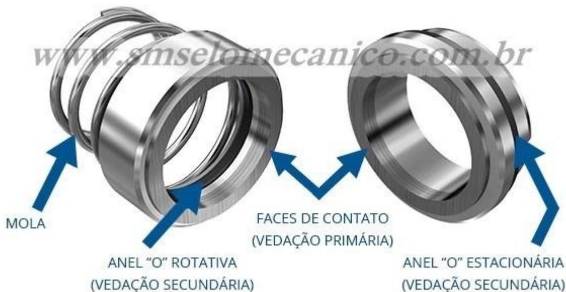
**Figura 34** – Selo mecânico tipo componentes (www.smselomecanico.com.br)
