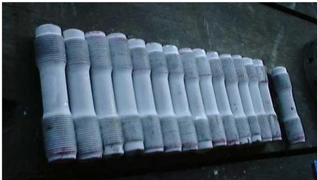
**Figura 10** – Inspeção de parafusos por líquido penetrante. (AFFONSO, 2012)
