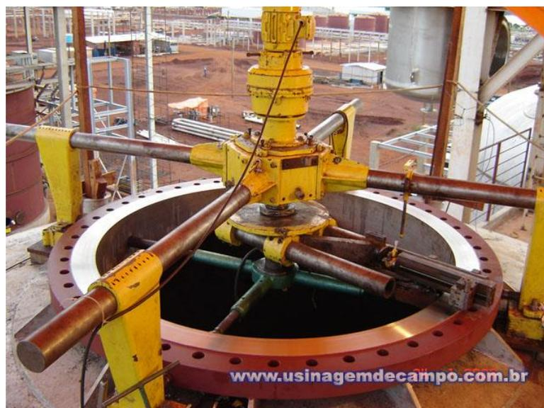
**Figura 5** – Usinagem de campo de flange de grande dimensão. (www.usinagemdecampo.com.br)
