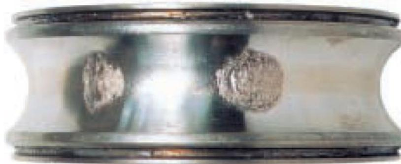
**Figura 28** – Rolamento com danos causados por impacto na montagem (NSK Brasil Ltda, 2001)
