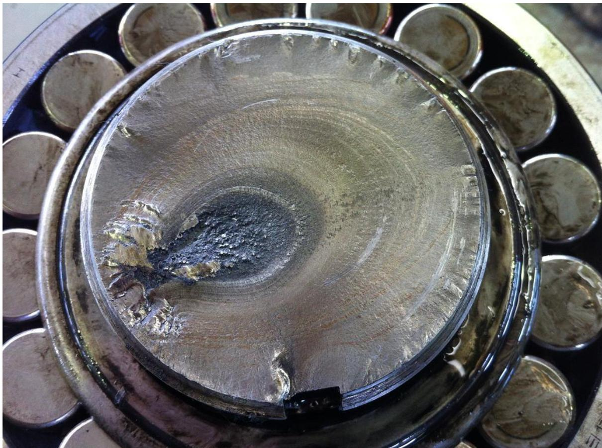
**Figura 2** – Aspecto característico de uma falha por fadiga, com as marcas de praia
