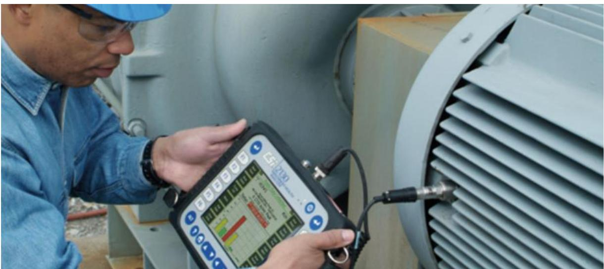
**Figura 1** – Análise de vibração em um motor elétrico. (<https://engeteles.com.br/manutencao-preditiva/>)
