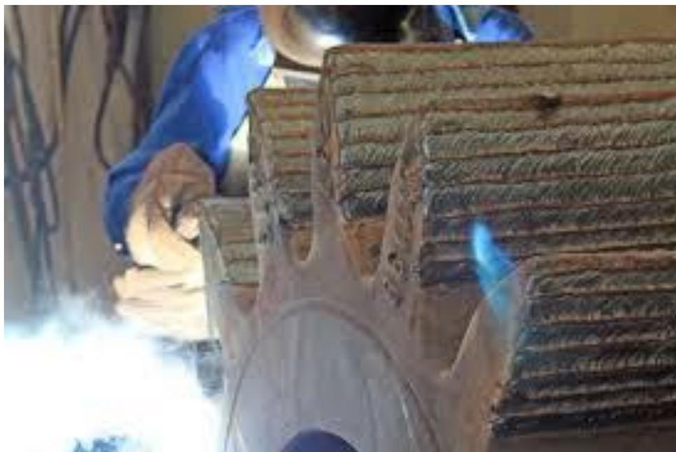
**Figura 6** – Recuperação de engrenagem com solda. ([www.controlsert.com.br](http://www.controlsert.com.br))
