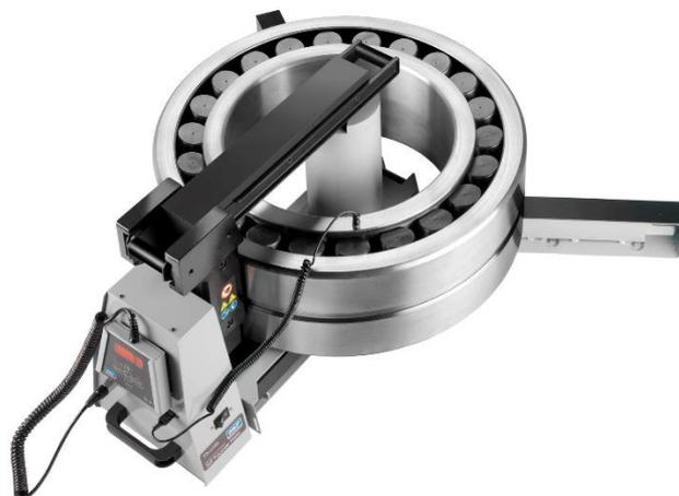
**Figura 32** – Aquecedor por indução para rolamentos (www.skf.com)
