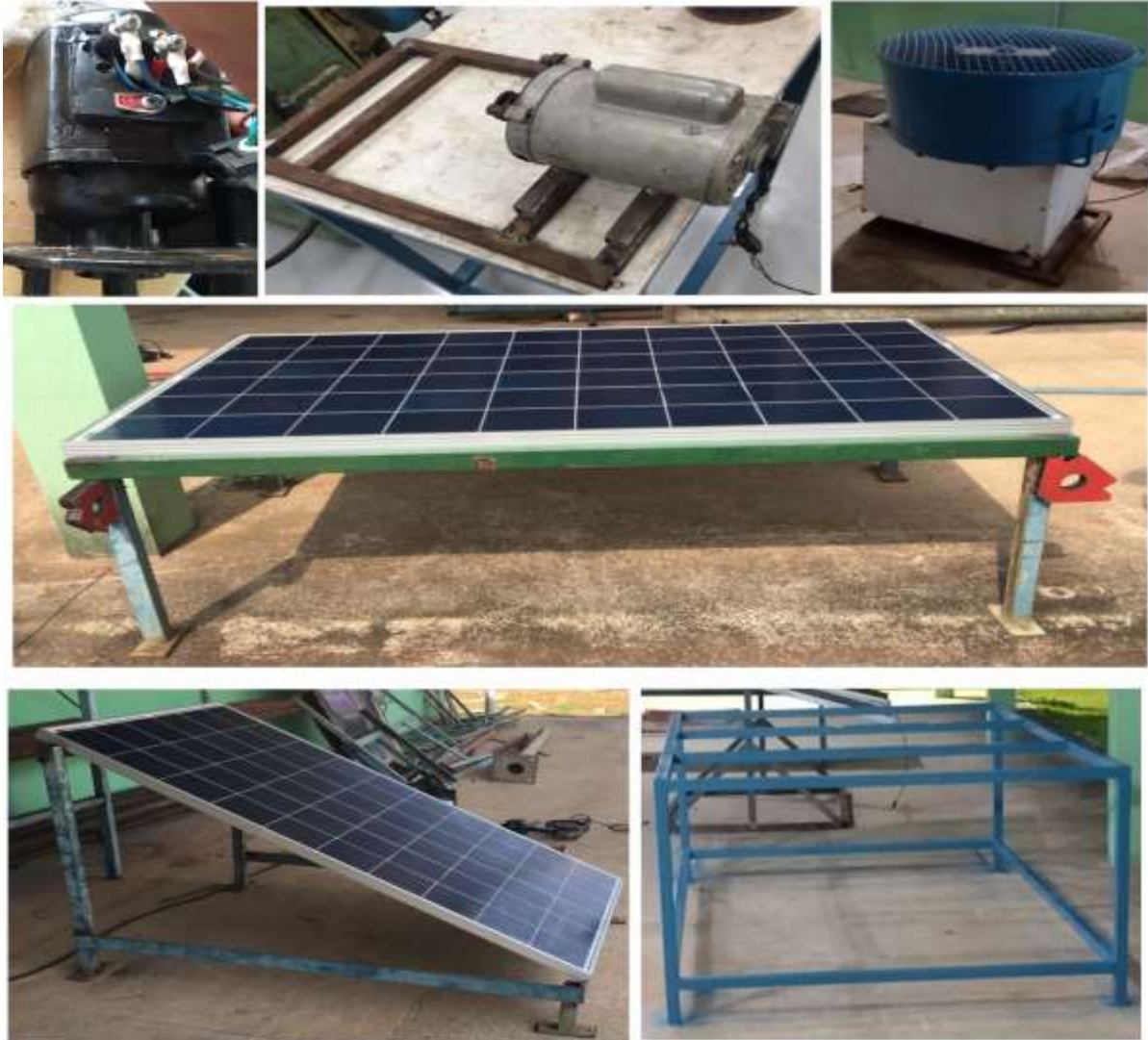
Figura 04: Atividades realizadas no laboratório de usinagem. Da esquerda superior para a direita: manutenção bomba de refrigeração, Bancada de alinhamento de motores, pintura e proteção misturador de areia, bancada para placa fotovoltaica horizontal, bancada para placa fotovoltaica inclinada, Bancada externo para trabalhos de caldeiraria.
