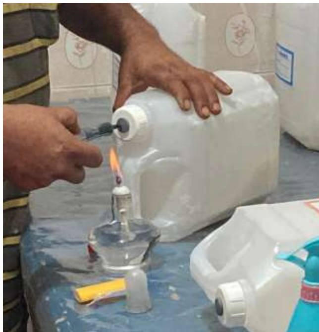
Figura 2: Inoculação do reator utilizando seringa.
