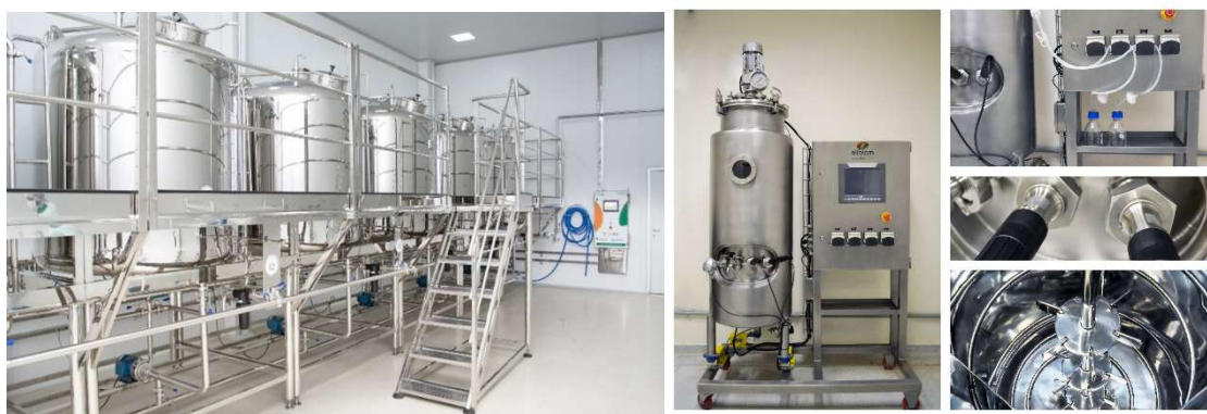
Figura 3 - Biofábricas on farm constituída por equipamentos em material sanitário e instalações com elevado padrão de controle para contaminantes. (a) Produto SoluBio® ; (b) Produto Allbiom®.
