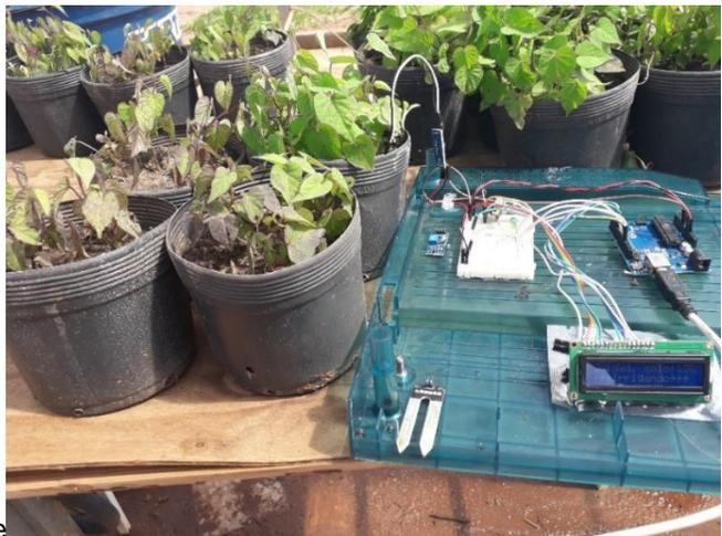
Figura 6– Modelo de sensor de umidade
