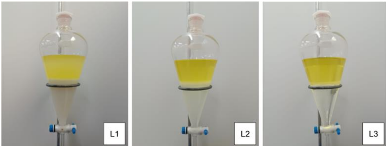
Figura 10 - Processo de lavagem do biodiesel de soja.
