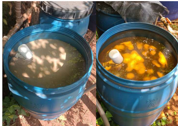
Figura 13 - (A) Imagem do leito do filtro após a instalação e (B) imagem após um mês de uso.
