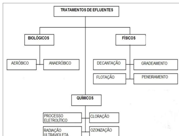
Figura 1 - Fluxograma dos processos de tratamento de efluente
