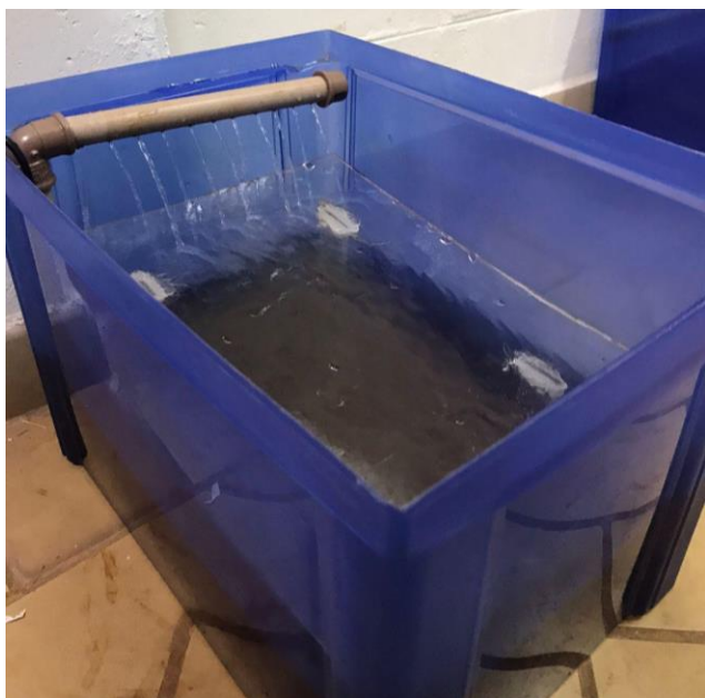
Figura 1- Estrutura do sistema de subirrigação para o cultivo de microverdes.
