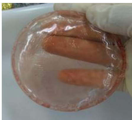
Figura 10 – Filme plástico obtido com FG plastificado com 5% de glicerol e 5% de PVA.
